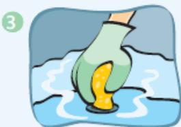
3 Feche as torneiras. Com um pedaço de esponja, tampe a tubulação de saída da água na caixa, evitando assim a entrada de qualquer sujeira na tubulação. Cuidado para não deixar a esponja entrar pela tubulação.
